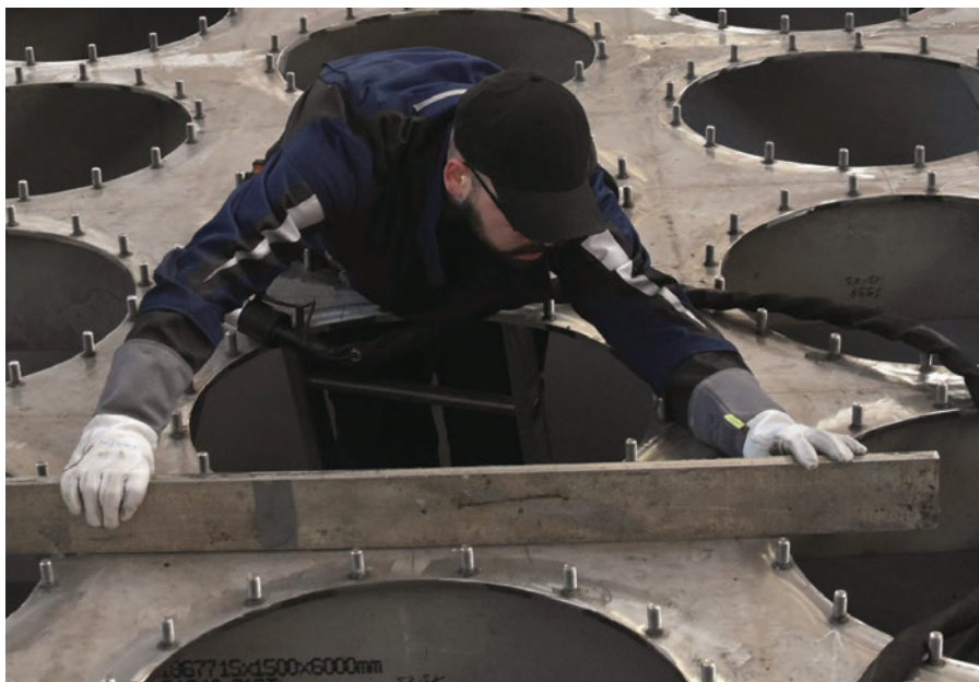
▲ Bild 12. Viel größeres Bauteil mit komplizierterer Geometrie, ähnlicher Werkstoff und gleiche Aufgabe: deutlich messbarer Verzug an diesem Kerzenfilterboden aus 1.4571
