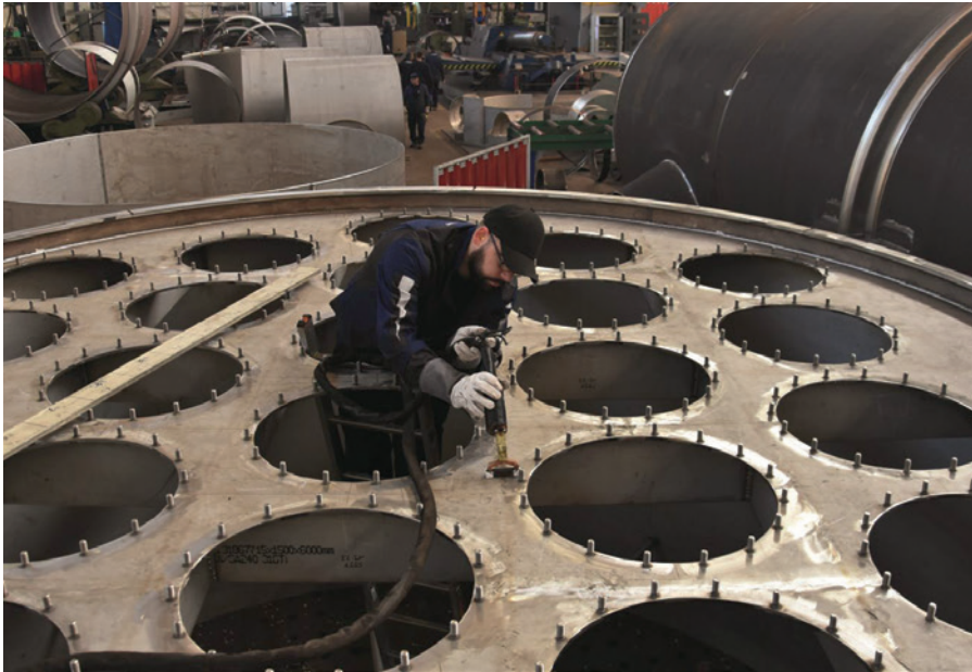
▲ Bild 13. In der Gesamtansicht wird die Größe des Bauteils sichtbar, hier wird mit einem zügigen Strich gerichtet.
