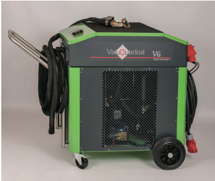
◀ Bild 6. Die hier beschriebenen Richtarbeiten werden bei Franken Apparatebau mit einem Tiefeninduktionsgerät „VauQuadrat V6“ mit bis zu 18 kW Induktionsleistung und erhöhter Kälteleistung ausgeführt (Stromanschluss: 3 × 400 V/32 A)
