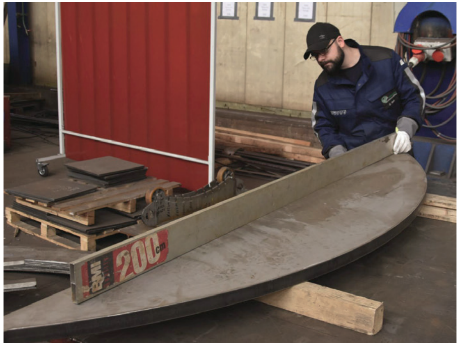
▲ Bild 9. Sven Boll misst den Verzug vor dem Richten – hier auf 2 m Länge etwa 5 mm.
