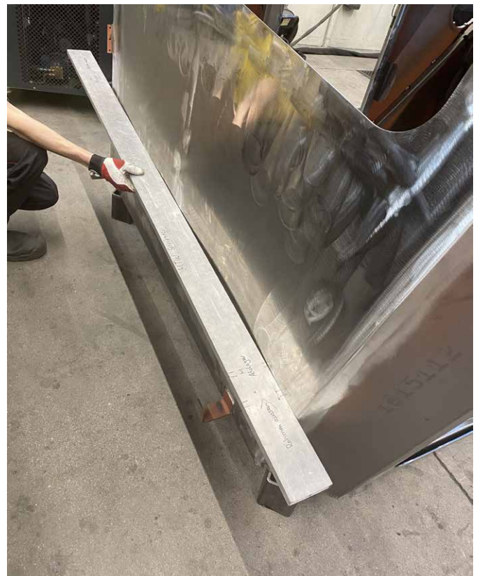
▲ Bild 2. Nach dem Schweißen wird aus dem ebenen Blech ein Beulfeld.
