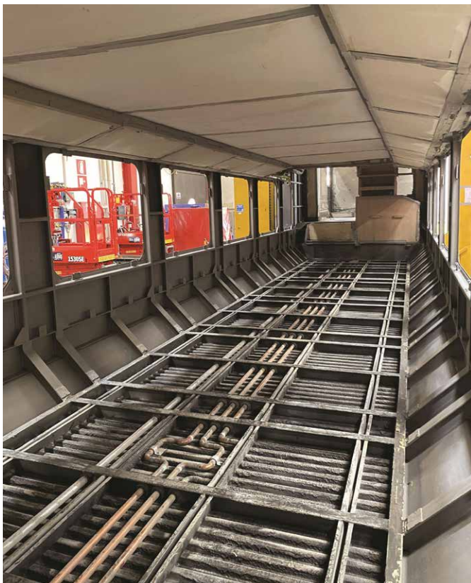
▲ Bild 1. Z-Profil-Struktur in einem Personenwaggon
