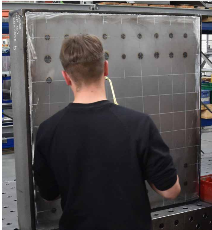
◀ Bild 4. Bei der Ausbildung zur Flammrichtfachkraft nach Richtlinie DVS 1145 ist dieses Beulfeld eines der Ausbildungsstücke.
