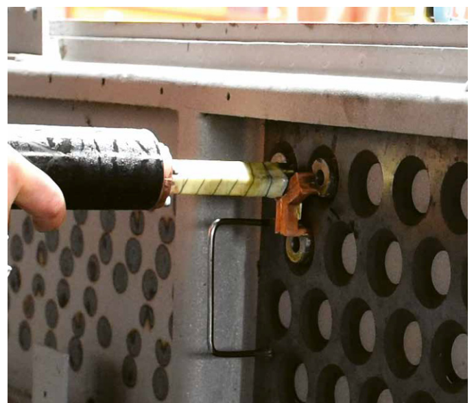
▲ Bild 13. ...und dann werden mit dem Dreieckinduktor in allen Löchern entsprechende Heizstellen timergesteuert gesetzt.
