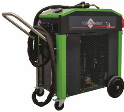
▲ Bild 20. Die hier beschriebenen Richtarbeiten wurden mit dem Tiefeninduktionsgerät „VauQuadrat V4“ der SBB Bellinzona mit bis zu 18 kW Induktionsleistung ausgeführt (Stromanschluss: 3 × 400 V/32 A inklusive Wasserkühlung).
