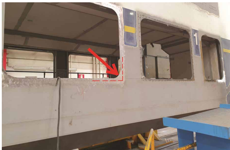
▲ Bild 8. Waggon-Rohbau in der Korrosions-Instandsetzung: Am linken Fenster sind die Ersatzbleche eingeschweißt (roter Pfeil), am rechten erst geheftet.
