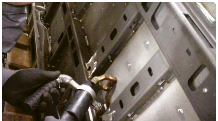
▲ Bild 5. Setzen von einzelnen Schrumpfungspunkten mit Tiefeninduktion
