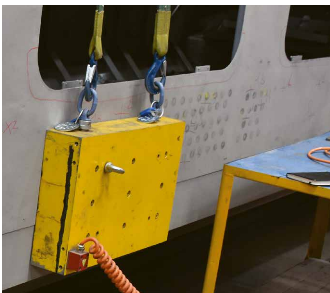
▲ Bild 12. ...die von außen durch eine starke Dipol-Magnetplatte angezogen wird,...
