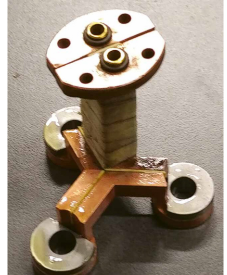
▲ Bild 10. Der Dreifleckinduktor ist zur Arbeit in einer Loch-Gegenplatte geeignet und erzeugt drei kreisrunde Richtflecke.
