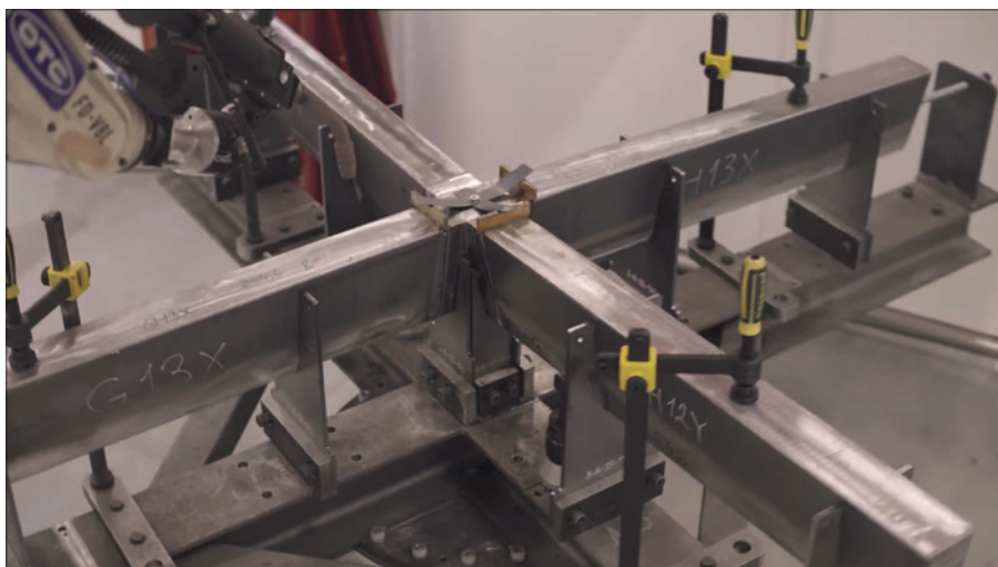
Bild 4: Die für die Bauteilfertigung in Pilsen und Gersthofen eingesetzte Schweißvorrichtung (© seele)
