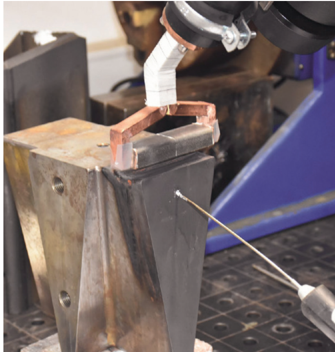
Bild 10: Der auf der Baustelle verwendete Induktortyp „Robbiduktor F Maxx“ während des Kleinprojekts zur Prozessfindung. Auf der Stirnseite des Profils ist ein spezieller Lack zu sehen, um gute Wärmebildaufnahmen zu bekommen. In das Loch in der Mitte ist ein Anlegefühler gesteckt, um genaue Temperaturinformationen zu haben. (© VauQuadrat GmbH)
